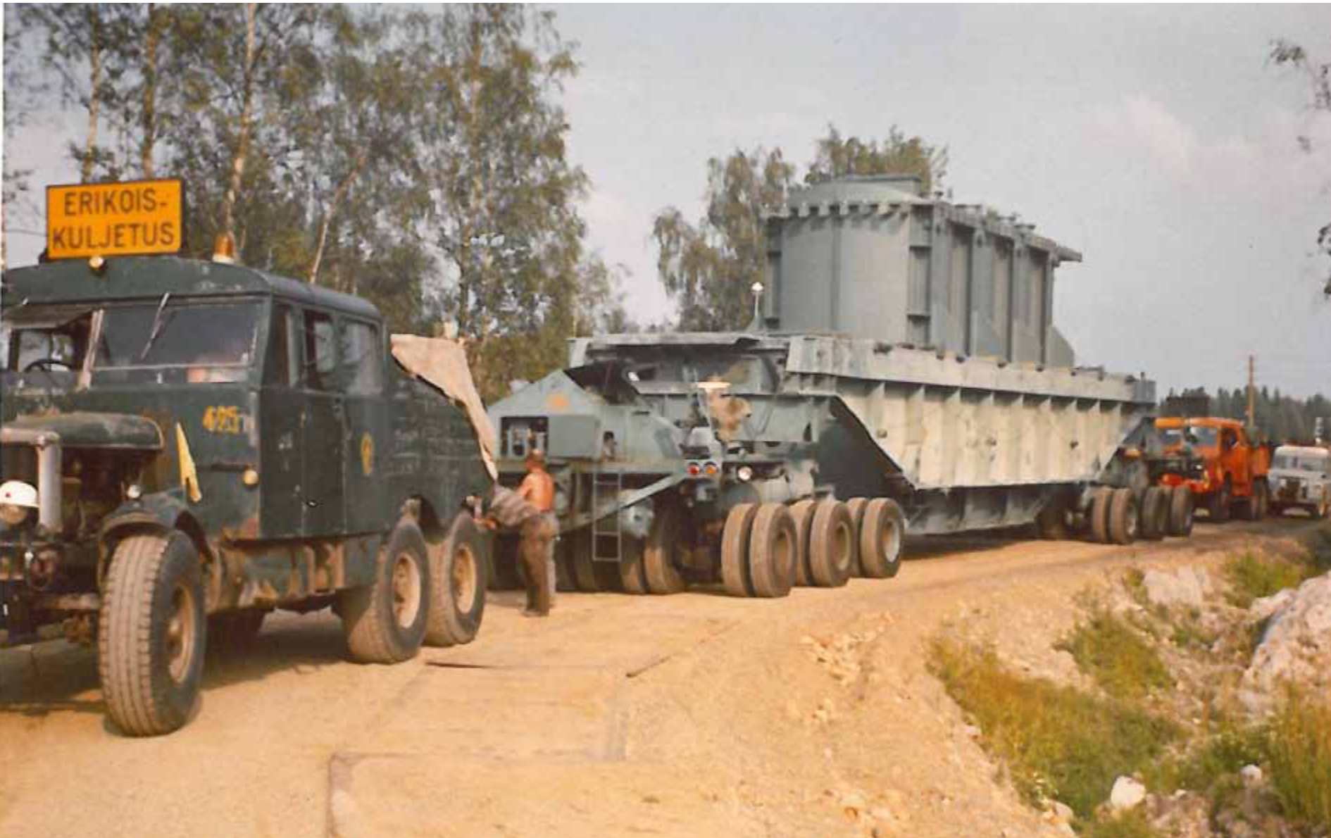
Tuovilan sähköaseman 220/110/20 kV:n 160 MVA muuntaja. Strömbergin tehtaalta Tuovilan asemalle junalla ja loppumatka maanteitse sähköasemalle. Kuljetuspaino oli noin 200 tonnia. IVO:n kuljetusosasto toi muuntajan 1971 tai 1972. (Joensuu)
